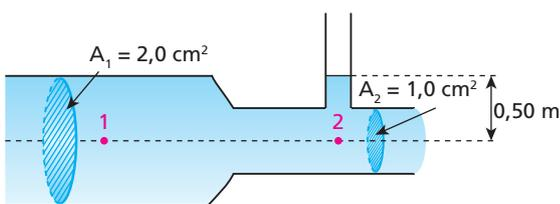
Adotando-se  $g = 10 \text{ m/s}^2$  e supondo-se o escoamento em regime permanente, pede-se para calcular a pressão efetiva no ponto 1, que é a diferença entre a pressão estática nesse ponto e a pressão atmosférica.
